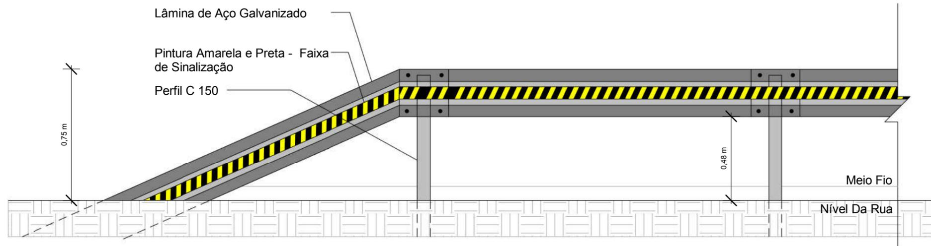
**Observação 01:** Todas as instalações de defesa maleável simples devem estar em conformidade e observar rigorosamente a NBR 6971/1999
