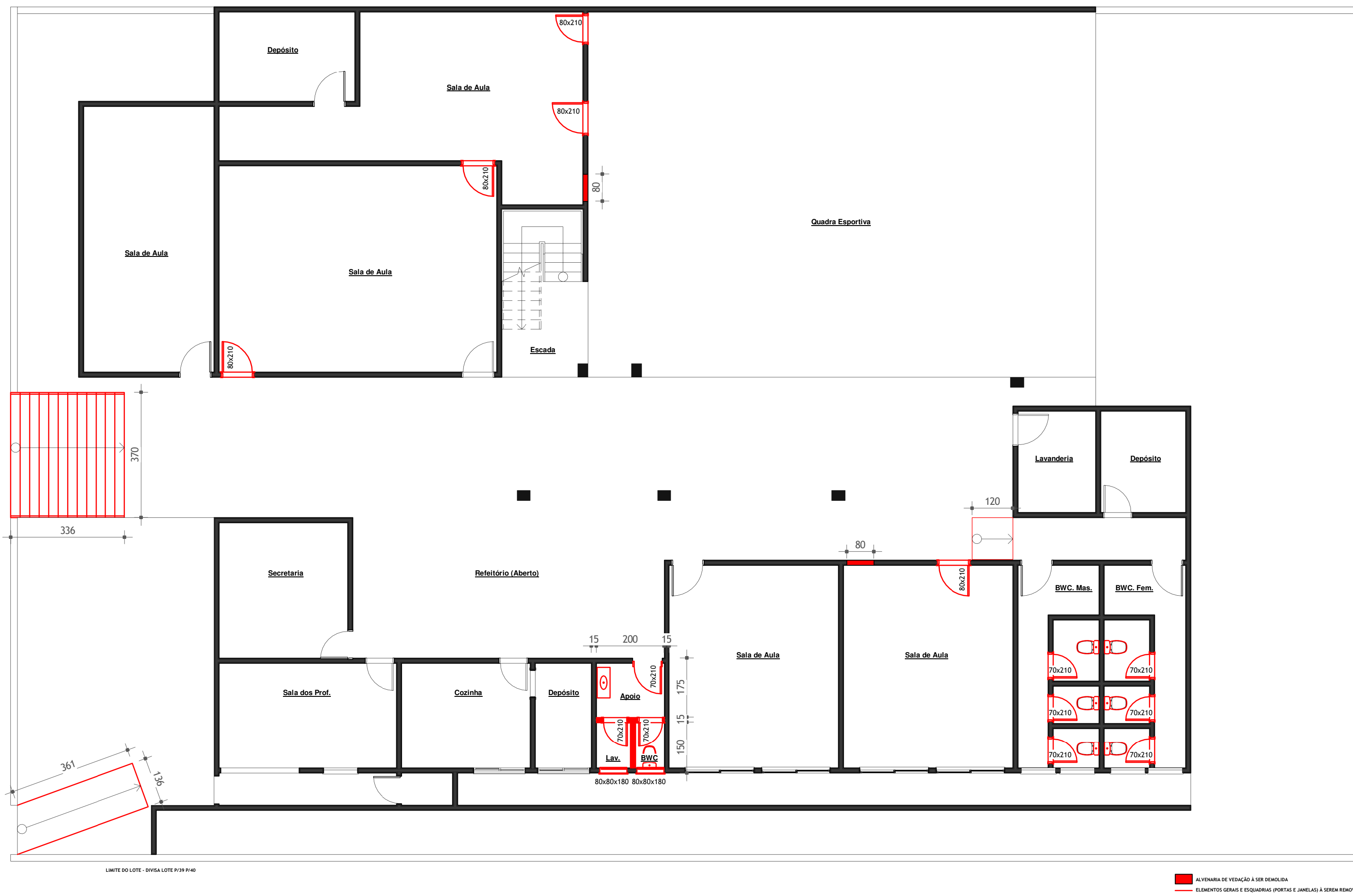
03 PLANTA BAIXA DEMOLIÇÃO/RETIRADA. ESCALA: 1/100.
